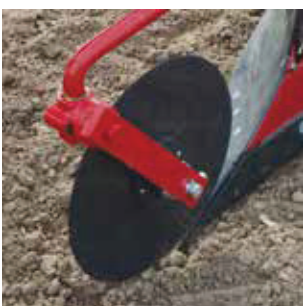
Ketasoad on võimalik tellida sirge servaga või hambulised, vedrukaitsega või jäigad.
